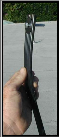
Los tirantes colectores son hechos de una tira de material colector cinco tubos de ancho por mas o menos 20" de largo, una rondana de acero y para este trabajo 1/4" x2" tornillos galvanizados serán usados. (tornillos no están incluidos en el equipo.) Corra el tornillo a través de la parte de en medio de el tubo para que 1/4" de la tira se extienda y pase la rondana.
